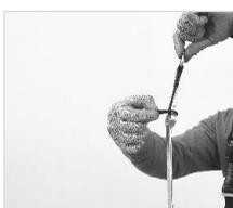
Agora, primeiro passe o laço pelo furo da ferramenta e depois passe a ponta do anel D pelo laço de fixação da ferramenta, formando um nó no furo da ferramenta.
