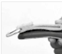
Coloque o conector da ferramenta de fixação na ferramenta de modo que o anel D fique livre para fixação da ferramenta.
