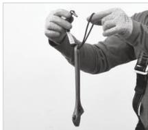
Primeiro, passe o laço pelo furo da ferramenta e depois passe a ponta do anel D pelo laço de fixação da ferramenta, formando um nó no olhal da corda.
