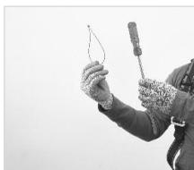
Este conector de ferramenta de arame pode ser conectado a ferramentas leves (por exemplo, chave de fenda).
