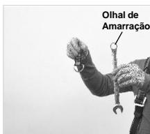
Este acessório de ferramenta pode ser acoplado a ferramentas leves que sejam fornecidas com um olhal de fixação (por exemplo, chave inglesa).
