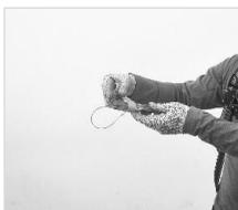
Coloque o conector da ferramenta no cabo da ferramenta de tal maneira que o laço fique livre para fixação da ferramenta. Agora, segure-o firmemente com fita de ferramenta.
