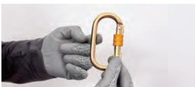
Passa o dedo indicador ao longo da superfície do conector para ver se há deformidades.
