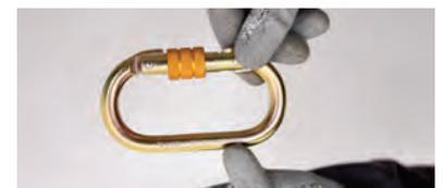
Sempre verifique a marcação no conector e se existe a possibilidades de corrosão na abertura e na trava do conector
