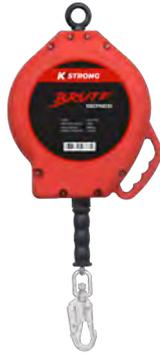
Dispositivos portáteis e independentes, conectados a um ponto de ancoragem acima da cabeça do usuário. Eles funcionam como um talabarte retrátil. O cabo de aço (ou fita) da linha de vida é conectada diretamente ao cinto de segurança do usuário. Ela se estende para fora do dispositivo à medida que a distância aumenta ou se retrai conforme o usuário se aproxima.
