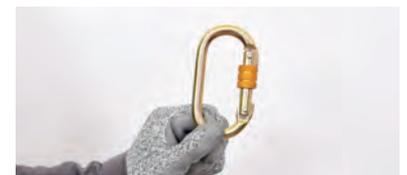
Verifique a abertura do conector - deve ser alinhado com a estrutura do conector.
