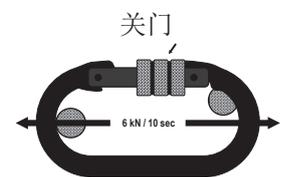
试验后，闸门应像新闸门一样打开。（门功能）
