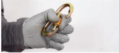
现在，通过3步操作检查连接器门的打开、关闭和锁定。
