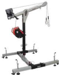
受限空间是指设计上入口和出口受限的空间。受限空间的例子包括储罐、工艺容器、船舶舱室、坑、筒仓、大桶、下水道、锅炉、隧道、拱顶和管道。为了进入和安全离开受限空间，可以使用吊柱、三脚架和绞车等设备。
