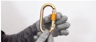
始终检查接头的锁止功能。它应工作平稳，接头应正确锁止。
