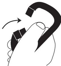
将闸门压入钩体内部，打开闸门
