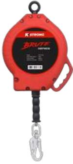
这些便携式独立设备固定在工作区上方的固定点上。它们就像一根自动拉紧的绳索。救生索或缆绳直接系在工人身上的皮带或吊带上。当距离增加时，绳索伸出设备，当使用者靠近时，绳索缩回。坠落因素发生的瞬间，该装备被激活以阻止坠落因素，同时内置减震器减少潜在的冲击负荷。这种装置非常适合在倾斜屋顶和倾斜结构上使用，因为绳索不会松弛，也不会干扰地面作业。
