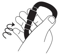
连接时始终锁定闸门连接时关闭闸门
