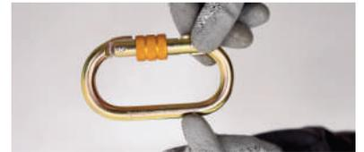
务必检查接头上的标记。检查连接器的门和锁是否生锈。
