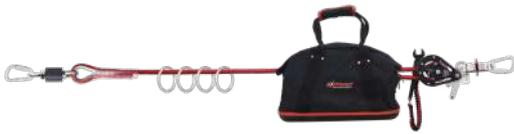
当使用者持续运动时在高架水平面上，水平生命线提供连续的锚定。它是一根锚缆，安装在同一水平面上的两个固定锚定点之间。该绳索可作为一个移动固定装置，用于连接系索、救生索或防坠装置。目的是通过在工人水平移动时提供连续的头顶支撑固定点来限制挥杆伤害。临时垂直锚线系统具有独特设计的绳索抓具，当他们移动时可以抓住它们，从而立即阻止坠落。
