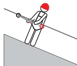
**Thiết bị sử dụng:** Dây đai an toàn toàn thân có các điểm liên kết chống rơi ngã phía sau hoặc phía trước, Bộ điều chỉnh dây và dây được chấp thuận có bộ giảm chấn. Neo mái tạm thời bằng kim loại hoặc dây treo có điểm neo.
