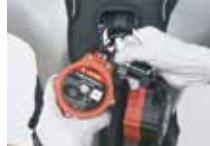
Bây giờ lắp Hộp dây Micron thứ hai vào.
