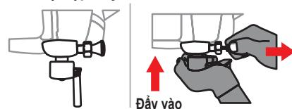
Kéo chốt và dây Tay quay để đảo ngược ở chế độ Hộp dây
