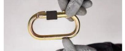
務必檢查連接器上的標記。檢查門和連接器鎖定部分是否有生鏽的可能性。
