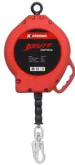
這些可攜式獨立裝置固定在作業區域上方的錨點點上，作用如同自動拉緊連接繩。防墜器鋼索或織帶直接連接到工作者的背負式安全帶上。當距離增加時，鋼索或織帶會從裝置中拉出，當工作者移近時則會回縮。一旦發生墜落，鎖定機制會啟動以制止墜落，同時內建的緩衝包會減少墜落衝擊力。此裝置非常適合用於斜屋頂和有角度的結構體，因為鋼索或織帶始終保持張緊，不會干擾到平面作業。
